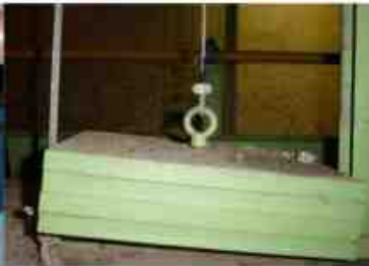
웨이트 고정 및 설치 상태 불량
