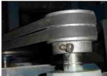
소켓 볼트 대신 일반 볼트로 키 고정됨(볼트도 파손)
